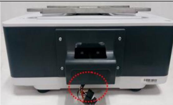
Вытащить разъем подключения дисплея из корпуса весов как показано на рис.
