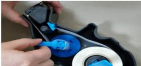
8. Зафиксируйте бумажную основу этикетки на голубом ролике. Защелкните пластиковый ограничитель для фиксации рулона
