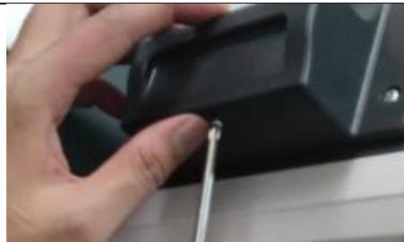
Прикрутите стойку на 4 винта и нижнюю крышку на место крепления стойки к корпусу
