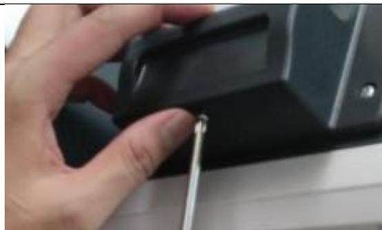
Установите на место нижнюю крышку крепления дисплея.
