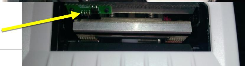
Очистить печатающую головку и опорный ролик при замене этикеток или при ухудшении качества печати.
