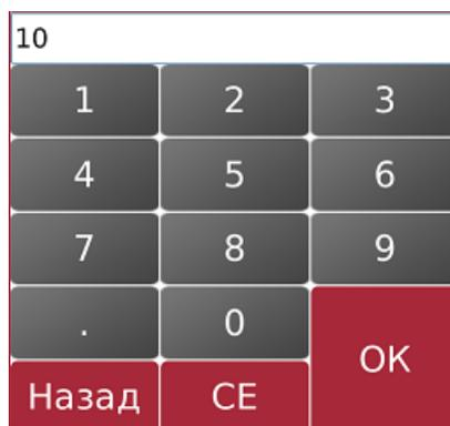
В поле «Тара» на экране весов теперь будет отображаться введенное значение веса тары. В поле «Вес» значение станет отрицательным, т.к. на платформе весов еще нет веса. В левом верхнем углу появится значок использования тары.
