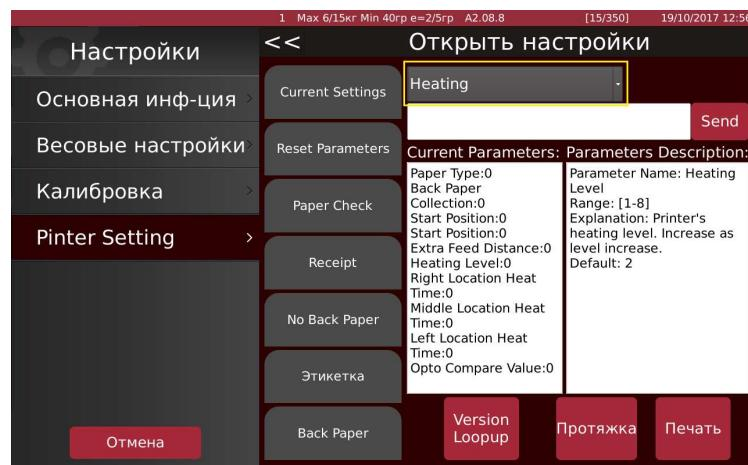
В средней части окна выводятся текущие значения. Интенсивность нагрева термоголовки меняются в пределах от 1 до 8. Чем больше значение, тем сильнее нагрев. По умолчанию установлена интенсивность 2.
