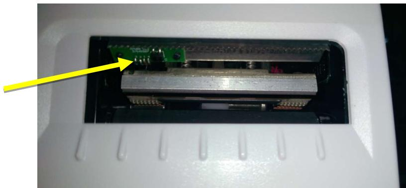
Очистить печатающую головку и опорный ролик при замене этикеток или при ухудшении качества печати.
