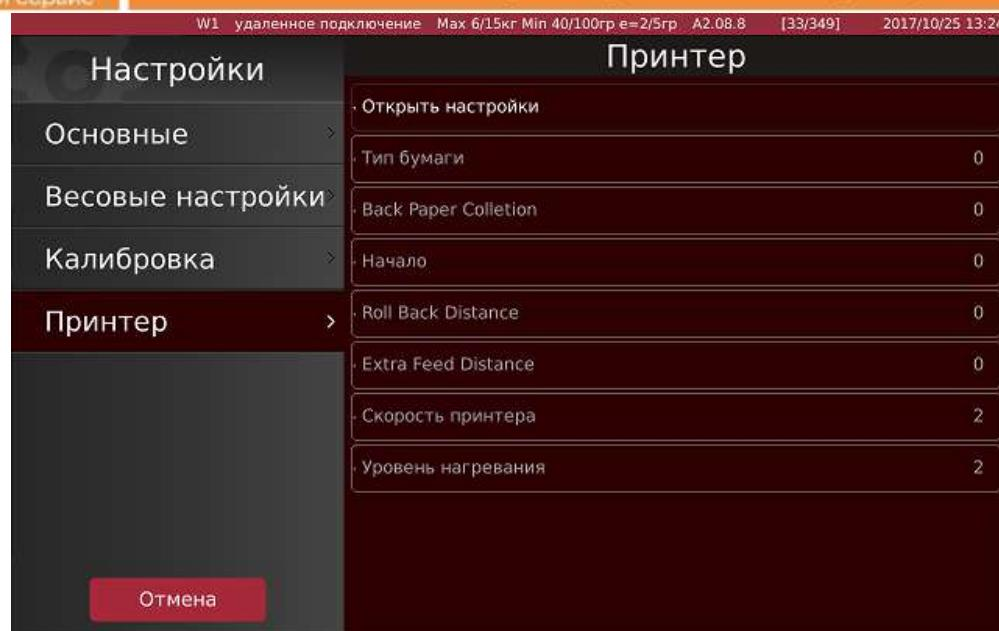
Нажмите «Открыть настройки», чтобы внести изменения и выберите параметр Heating в верхней части окна – это настройка нагрева термоголовки:
