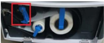
10. Поверните рычаг фиксации термоголовки по часовой стрелке для перевода в рабочее положение
