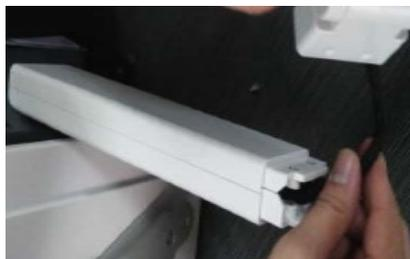
6. Протяните кабели через стойку вверх так, чтобы лишние провода не мешались в нижней части стойки.
