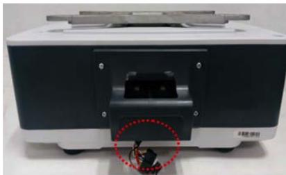
1. Вытащить разъем подключения дисплея из корпуса весов как показано на рис.
