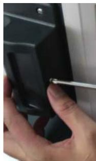
8. Прикрутите нижнюю крышку на место крепления стойки к корпусу
