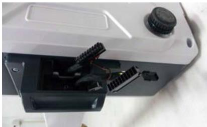
3. Разъемы дисплея вид снизу до подключения
