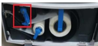
2. Поверните фиксатор термопечатающей головки против часовой стрелки для извлечения рулона.
