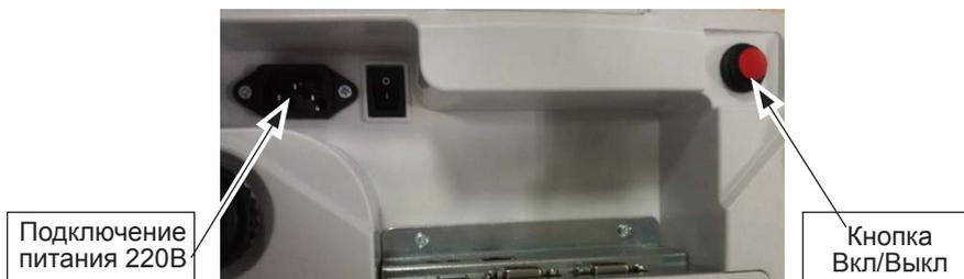
Кабель питания подключается к розетке переменного тока. Подключаемое оборудование должно быть установлено рядом с легкодоступной розеткой 220В с заземлением.
