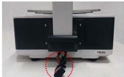
2. Пропустите кабель от дисплея через отверстие в креплении стойки. Установите стойку в крепление.
