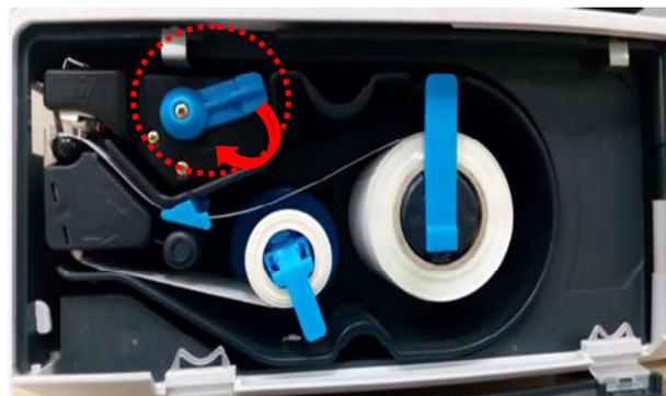
⑥ Вставить кассету и повернуть рукоятку термоголовки в закрытое положение
